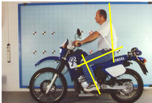
Figure 3 : exemple de positionnement du pilote sur une machine du type 125 cm3 trial
