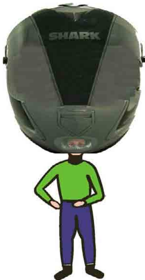
Fig n°5 : taille théorique d'un casque capable d'absorber l'énergie d'un choc survenant à 64,4 km/h 11 (pilote mesurant 175cm)
