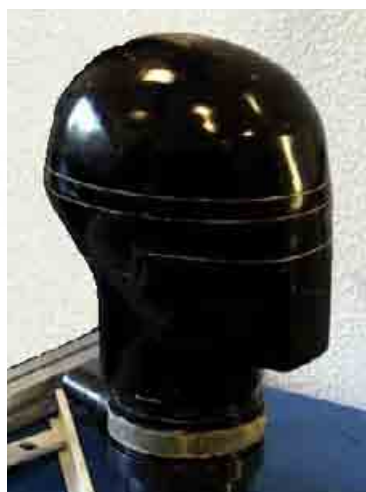
Forme globale de la « fausse tête » décrite dans la norme ECE 22
