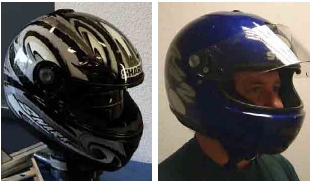
Différence de positionnement entre un casque posé selon les préconisations de la norme et la réalité (nuque droite pour les deux casques).
